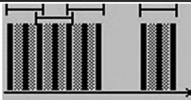
На рисунке вертикальный длинный отрезок обозначает сигнал о нажатии. Проигнорированные сигналы находятся в заштрихованной области.
